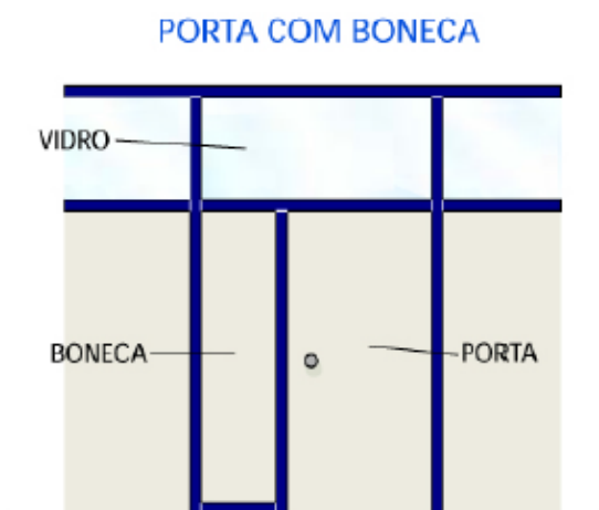
Figura 05: Instalação de porta
